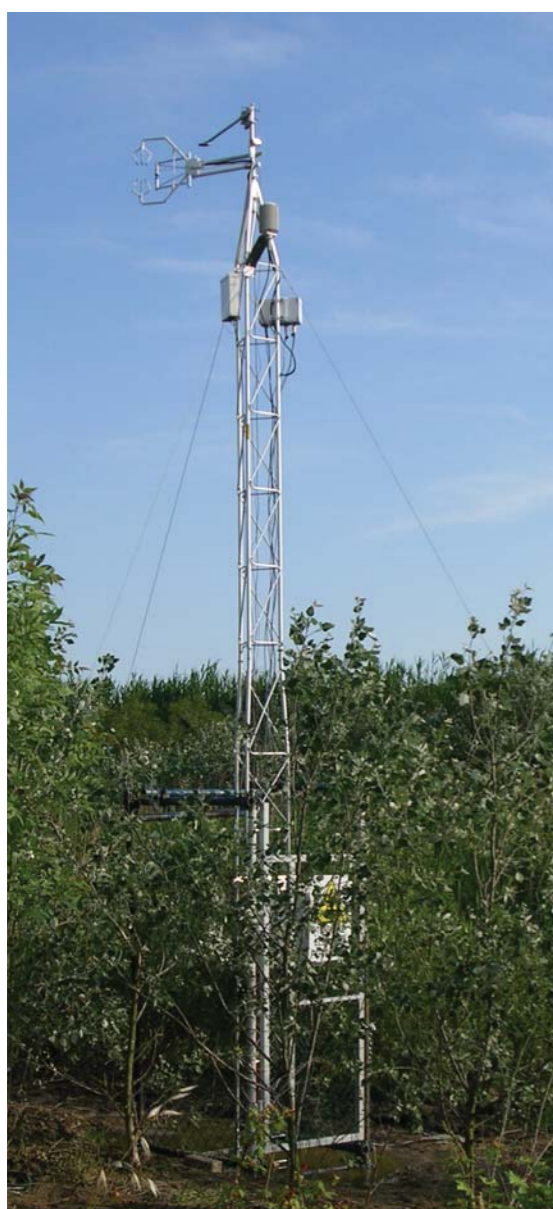
IN ALTO: Sistema di misura dell'evapotraspirazione.
